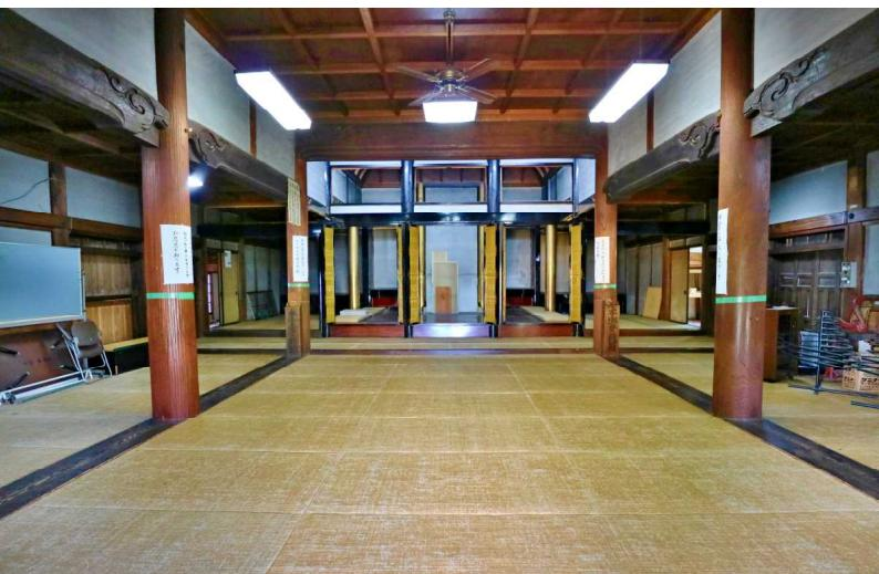
参詣席は（新 $154.83\text{m}^2$  ÷ 旧 $81.95\text{m}^2$  =）約1.9倍の広さに。屋根の骨組みを合掌トラス構造にすることで中央に柱のない広い空間を確保。天井高は4.83m、8畳用LEDシーリングライトを42個設置、サッシも全面二重ガラスで明るくなりました。最大250並ぶ椅子席を前提に50cm高に設定した外陣（げじん）を舞台に多目的ホールとしても活用します。
